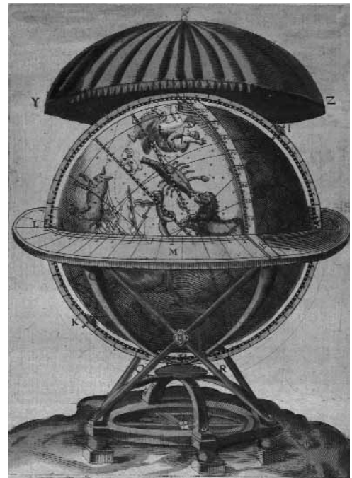
Figur 4. Globus Magnus. Tycho tegnede alle de stjerner, han målte på himlen, på en stor himmelglobus i træ.
